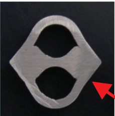
焊缝在非关键拐弯处，无任何尺寸变化
