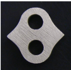
采用实心型材制作，无缝隙
